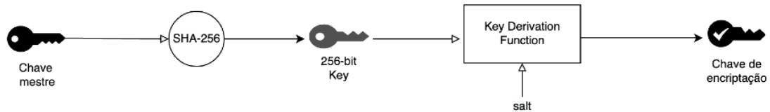
Figure 4: Processo de compressão e derivação da chave mestre do utilizador
